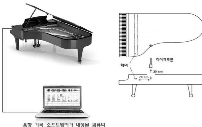
〈그림 2〉 피아노 음향 녹음을 위한 장비 배치 개략도
